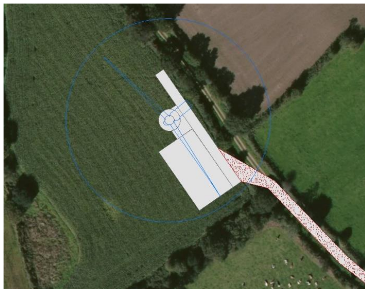
Nouvelle implantation limitant l'impact sur le talus
